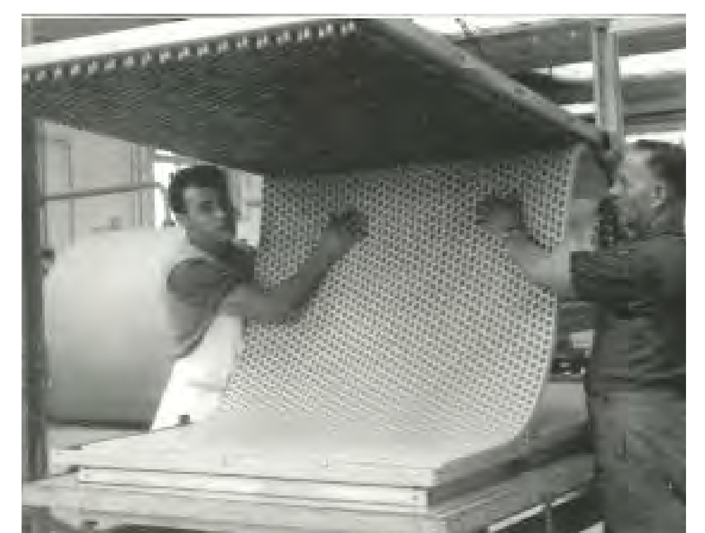
Vor und nach der Vulkanisierung der Latexplatten
