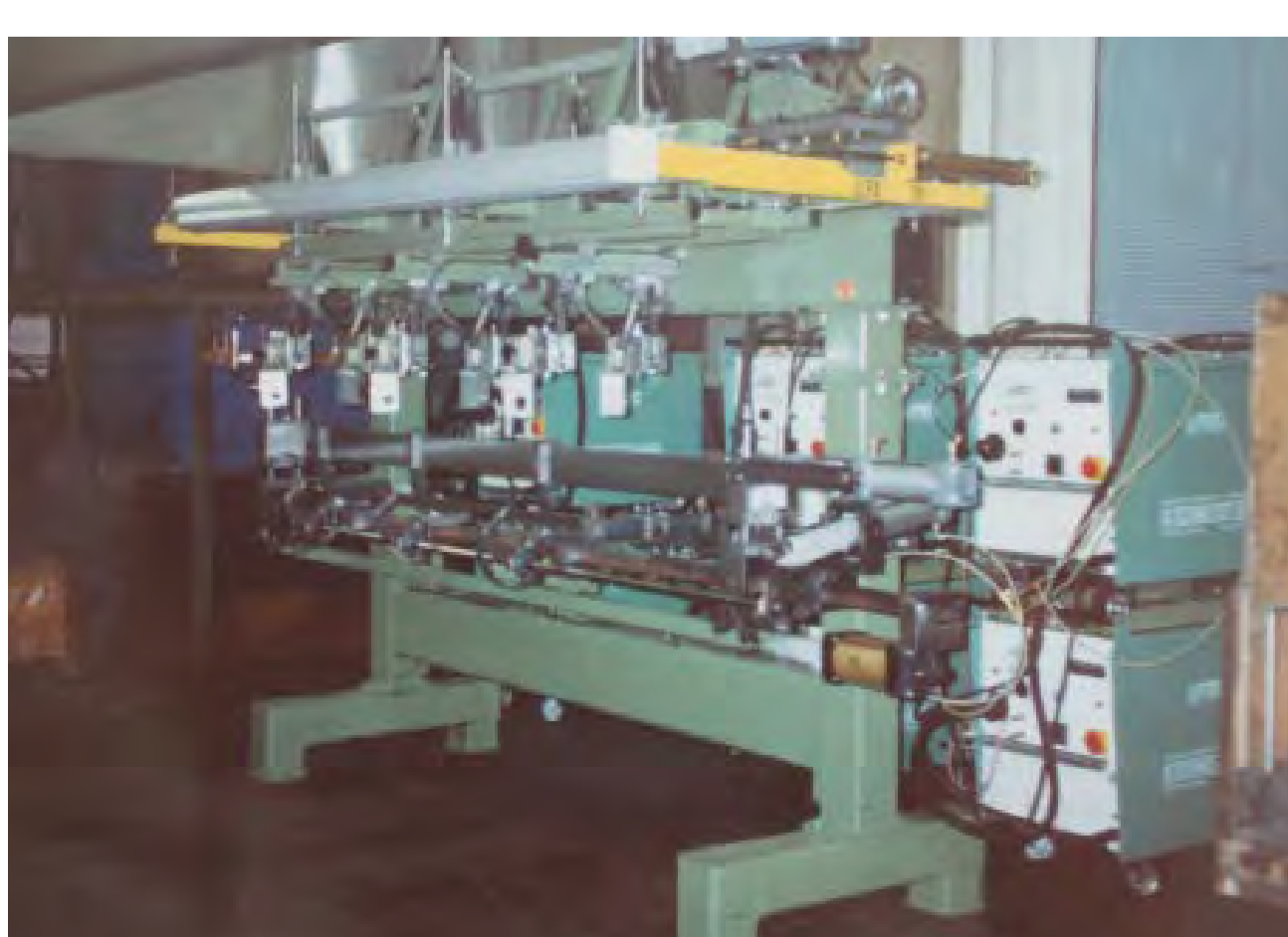
Intern entwickelter, neuer Schweißautomat „Alpha 64“
